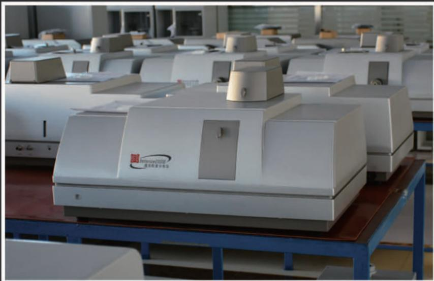
( 高精度双镜头超细激光粒度仪 )
